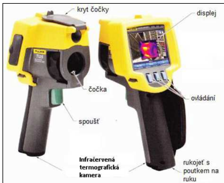
Obr. 18 Popis infračervené termografické kamery [5]
