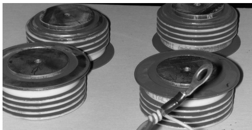
Foto č.6.: Polovodiče z bezkontaktního budiče
