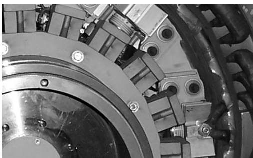
Foto č.8.: Bezkontaktní budič generátoru
