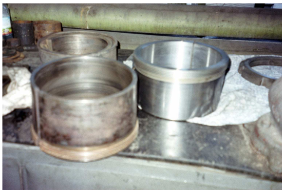
Obr.č.4.: Poškozená a dobrá vložka ložiska
