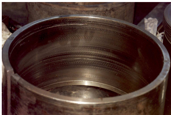
Obr.č.5.: Poškozená vložka ložiska
