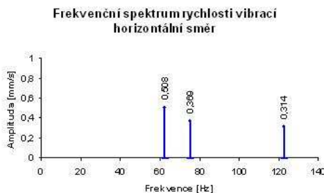
Obrázek č. 14. 13: Frekvenční spektrum rychlosti vibrací měřených v bodě C1H
