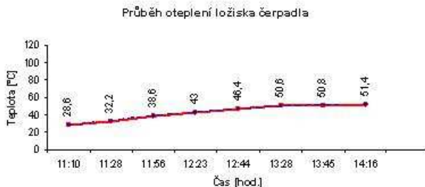
Obrázek č. 14 .5: Průběh oteplení ložiska čerpadla NU2224 bod C1
