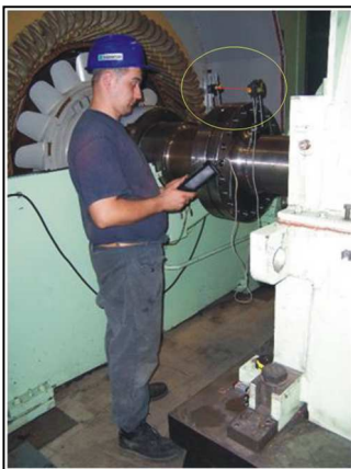
Obrázek č. 14.49: Kontrola ustavení generátoru s převodovou skříní
