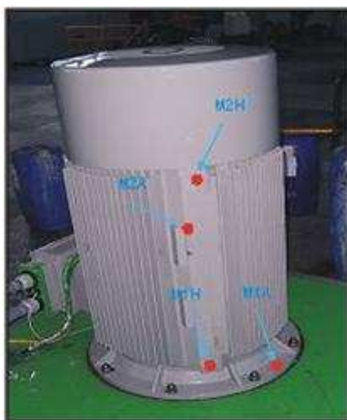
Obr. 14. 2: Vyznačení měřících bodů na elektromotoru
