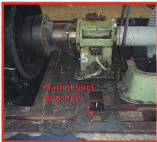
Obrázek č. 14. 30: Doplnkové připevnění rámu k základu šrouby
