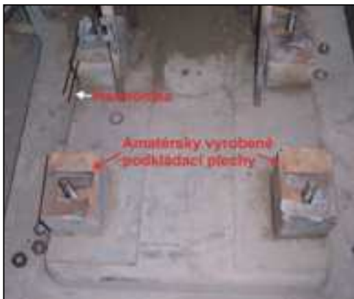
Obrázek č. 14.37: Ukázka špatných podkladacích plechů pod patky elektromotoru a taktéž silné vrstvy zvané „harmonika“
