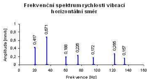
Obr. 14. 8: Frekvenční spektrum rychlosti vibrací v měřícím bodě M2H
