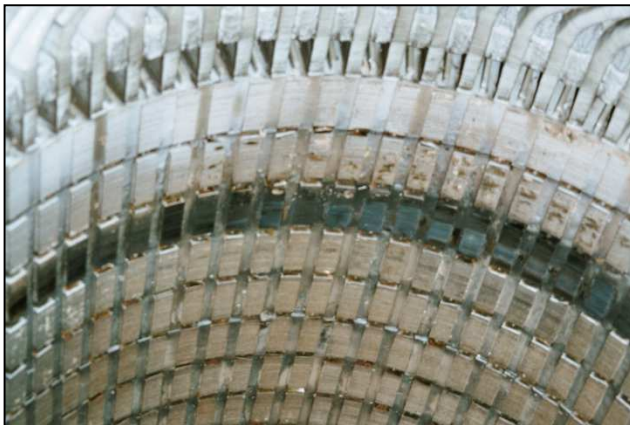
Obrázek č. 14.64: Poškozený magnetický obvod statoru
