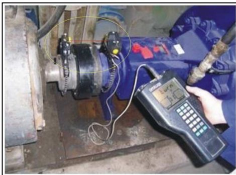
Obrázek č. 14.50: Ustavení elektromotoru a vodního čerpadla
