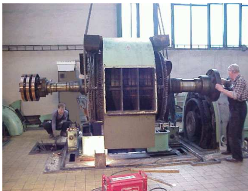
Obrázek č. 14. 26: Demontáž elektromotoru
