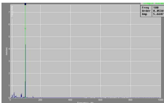
Obrázek č. 14.58: Frekvenční spektrum jednoho z měřících bodů špatně diagnostikovaného elektromotoru
