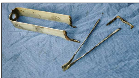
Obrázek č. 14.62: Vypálené odporové segmenty spouštěče
