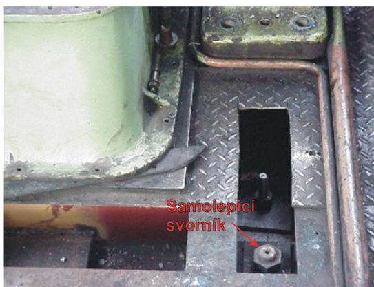
Obrázek č. 14. 29: Doplňkové připevnění rámu k základu šrouby
