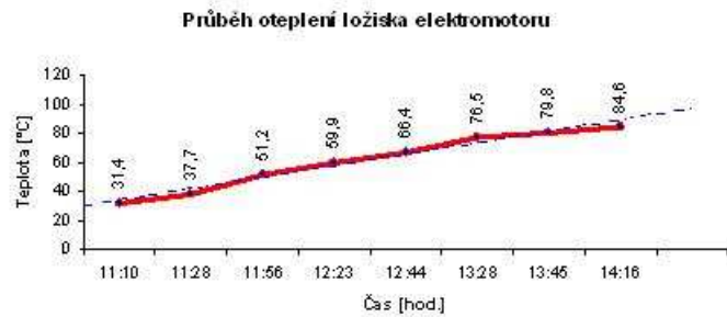
Obr. 1.3. Průběh oteplení axiálního ložiska elektromotoru NU 322 bod M1
