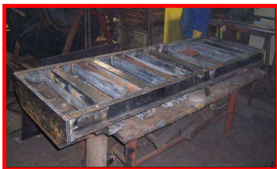
Obr. 2. Demontovaný základový rám
