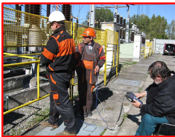
Obr. č. 8.: Měření dotykového napětí na zábradlí rozvodny 110 kV
