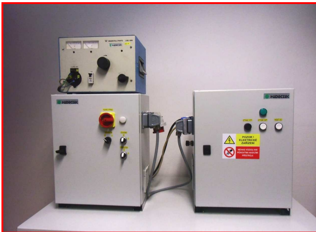
Obr. č. 5.: Měřicí souprava pro měření uzemnění a dotykových napětí bez měřících přístrojů vyrobená firmou HUDECZEK SERVICE, s. r. o. Albrechtice
