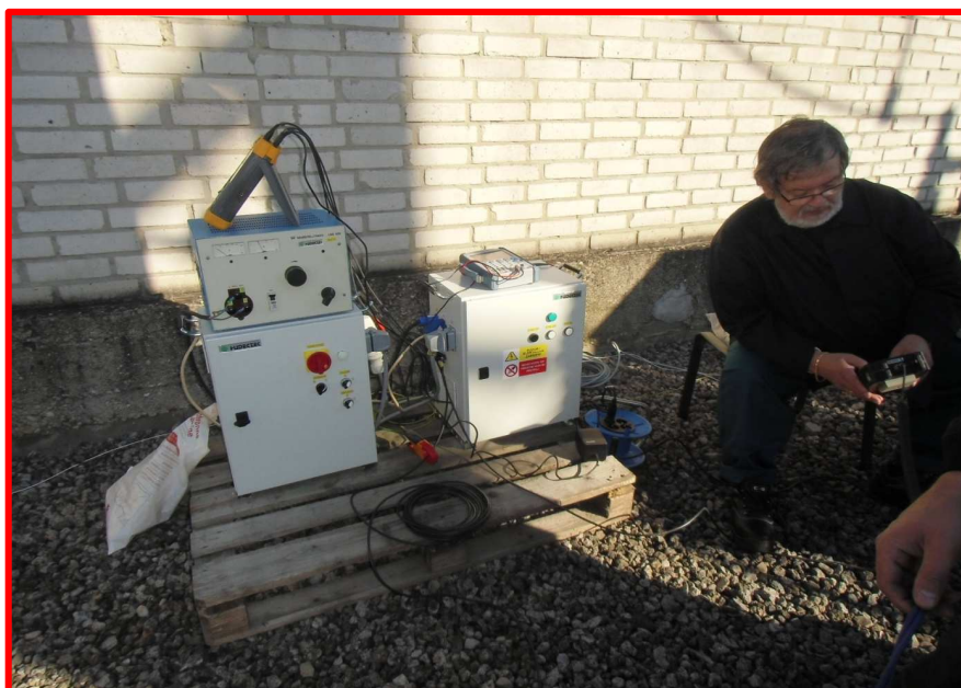
Obr. č. 6.: Měřicí souprava pro měření uzemnění a dotykových napětí včetně měřících přístrojů, na konkrétní rozvodně 110 kV, která je vyrobená firmou HUDECZEK SERVICE, s. r. o. Albrechtice
